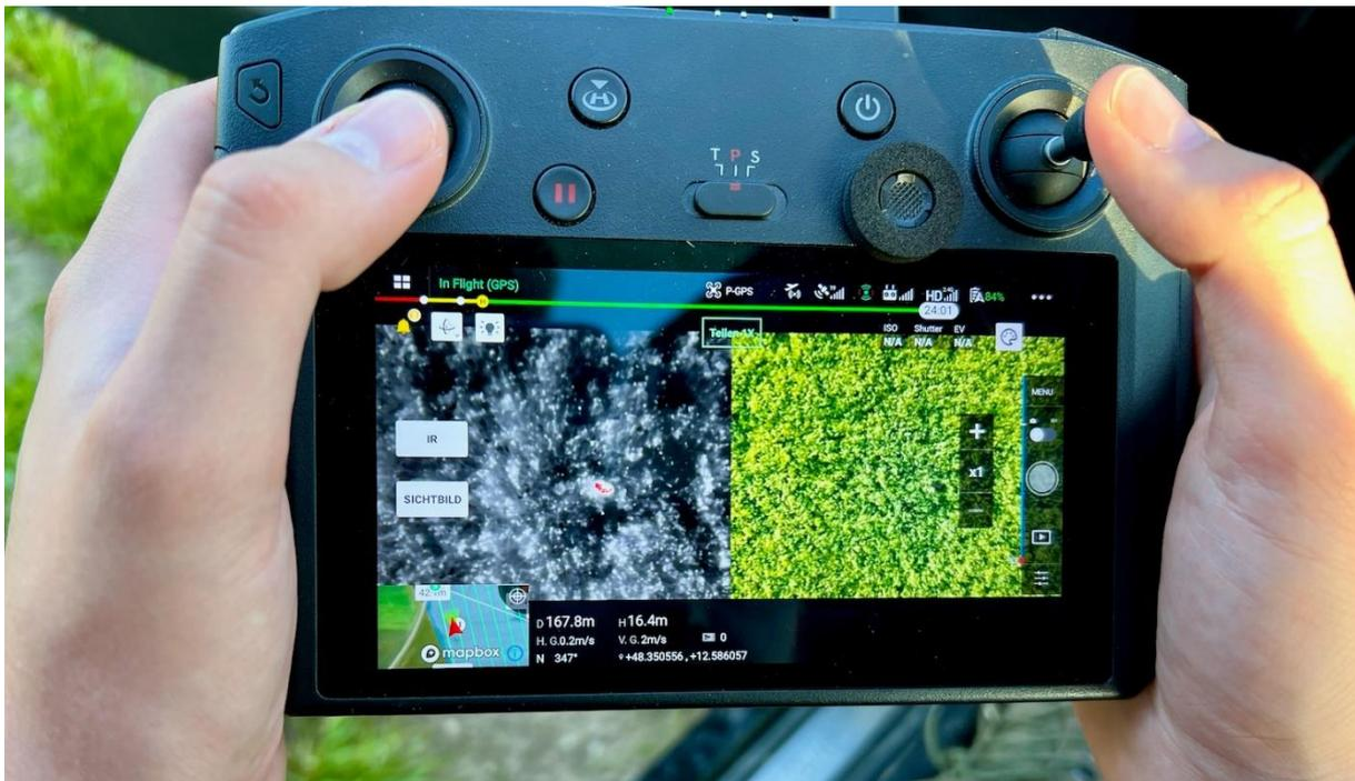
Der Controller der Drohne zeigt Foto und Wärmebild mit Kitz (roter Punkt).
