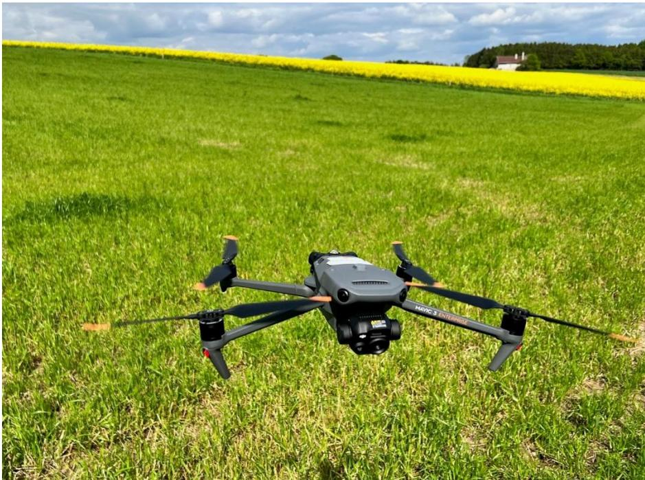
Der Einsatz einer Drohne mit Wärmebildkamera vermeidet den Mähtod zahlreicher Rehkitze
